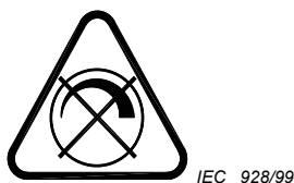
Figure 1 – Utilisation avec un gradateur interdite
